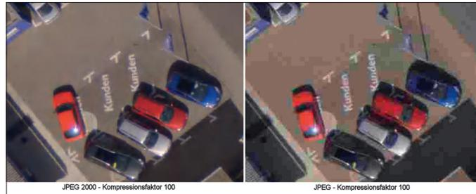
Abb. 6: Vergleich von JPEG2000 und JPEG bei hohem Kompressionsfaktor (Dateigröße 6 MB)
